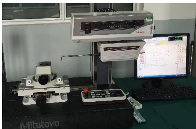
图 6-5 PRSM 螺纹牙测试用轮廓仪
