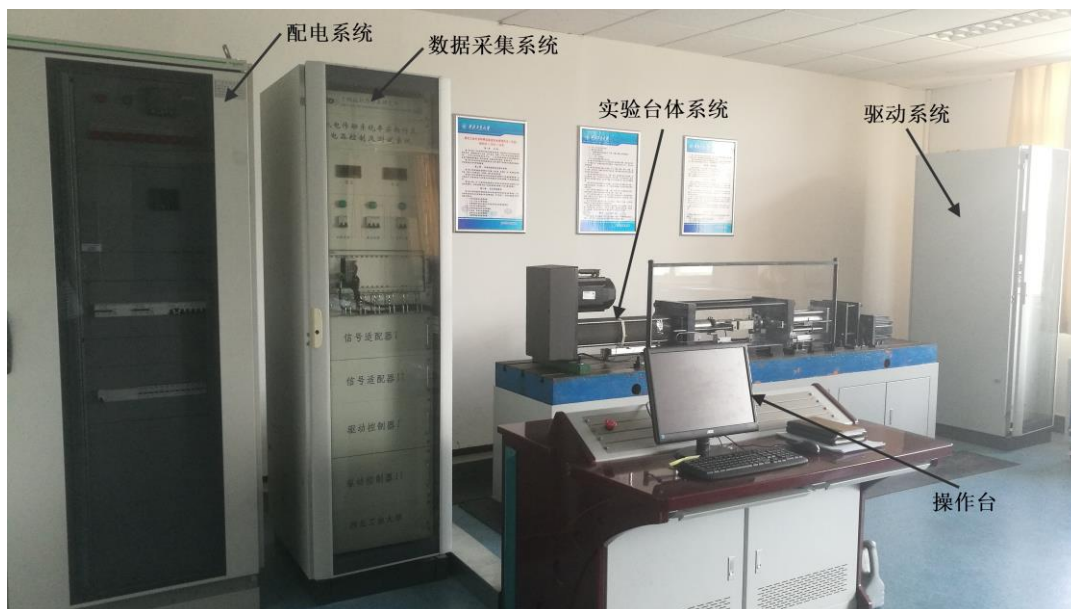
图 6-2 PRSM 综合性能实验台
