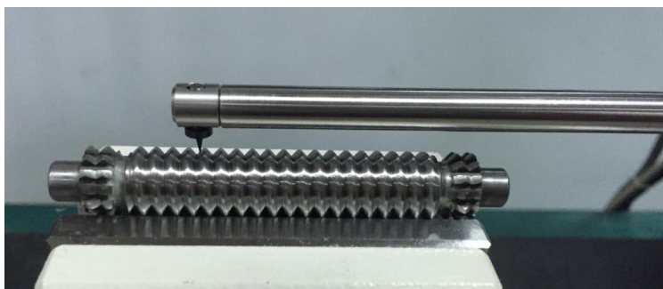
图 6-6 滚柱螺纹加工误差测试
