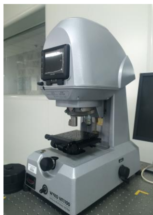
图 6-18 三维表面光学干涉仪（WYKO NT1100）
