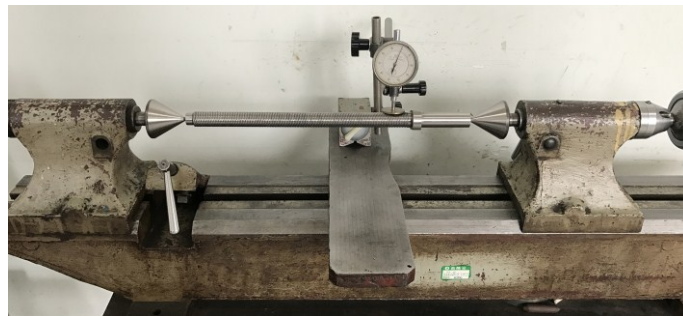
图 6-18 丝杠螺纹加工的偏心误差测量
