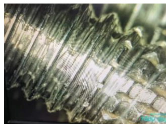
(a) 清洗前螺纹牙表面
