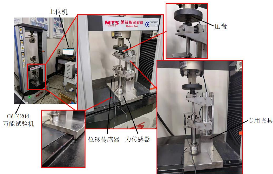
图 4-22 IPRS 静载实验装置
